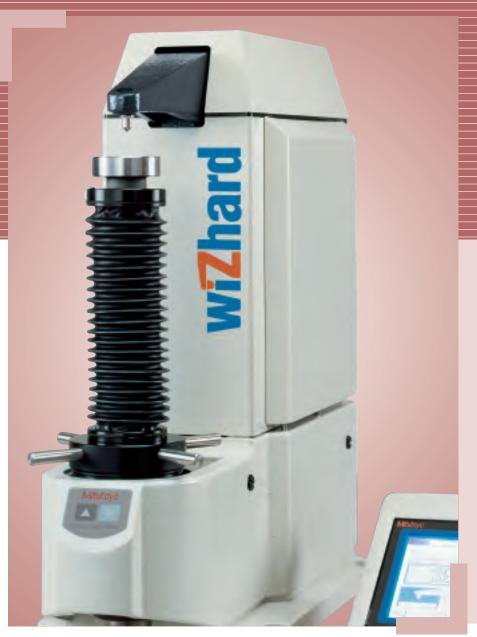
Rockwell / Rockwell Superficial / Brinell hardness tester
